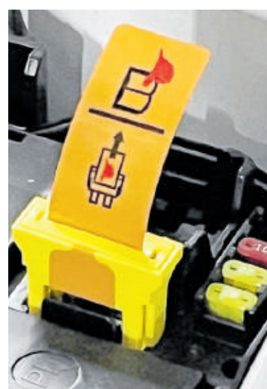
So sieht ein Disconnect-Stecker mit dem Feuerwehrhelm aus.
